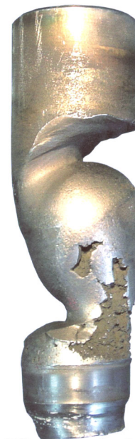
Rys. 6 Uszkodzenia elementów zaworu w wyniku flashingu
