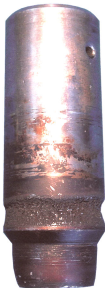
Rys. 5 Uszkodzenia elementów zaworu w wyniku kawitacji
